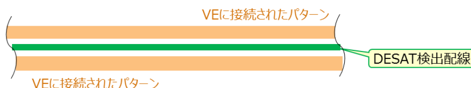
図 3.2 DESAT 回路配線パターンのシールドイメージ
